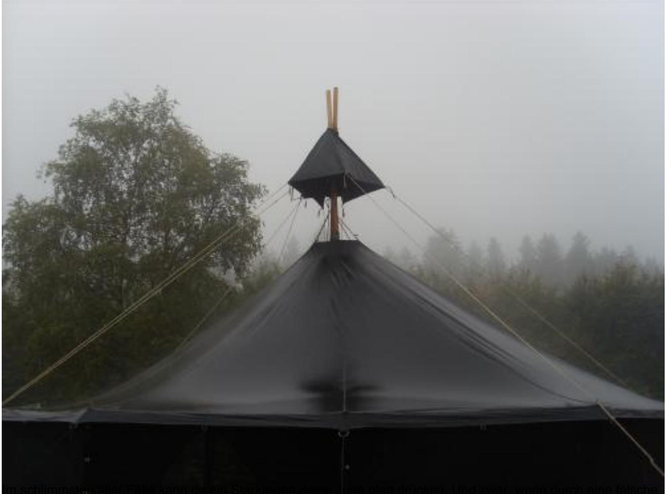
Spannung im Dach Wassersäcke entstehen, die sich immer weiter füllen, bis sie letztendlich zu schwer werden.
