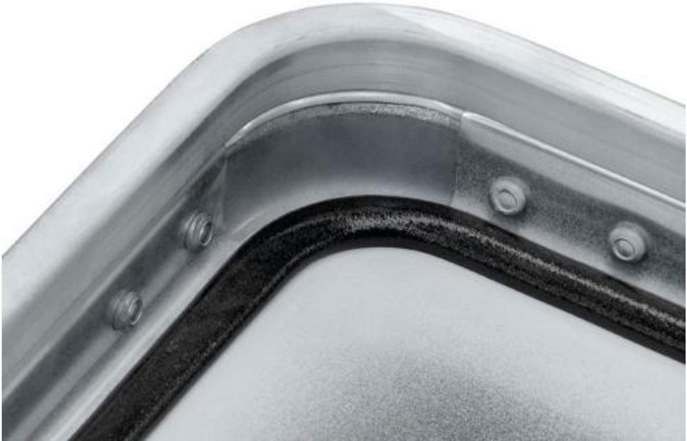
Willst du in der Kiste im Sommerlager Lebensmittel lagern? Dann sollte sie auch dicht sein, damit kein Schmutz, kein Wasser und vor allem kein Getier seinen Weg in die Kisten findet. Eingeklebte Dichtungen nutzen irgendwann an. Umlaufende Dichtungen, welche direkt eingeschäumt werden sind besser, beugen dem Verschleiß vor und sind vor Überlastung und Abquetschung geschützt.
