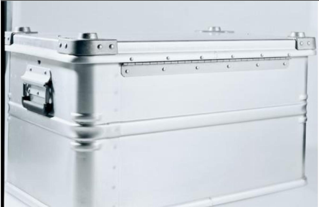
Zu einer dichten und robusten Kiste gehören auch Scharniere aus Edelstahl, welche mit Vollnieten angebracht werden. Möglichst sollten diese in den Vollprofilen des Deckels vernietet sein, dies sichert am besten gegen das Ausreißen.
