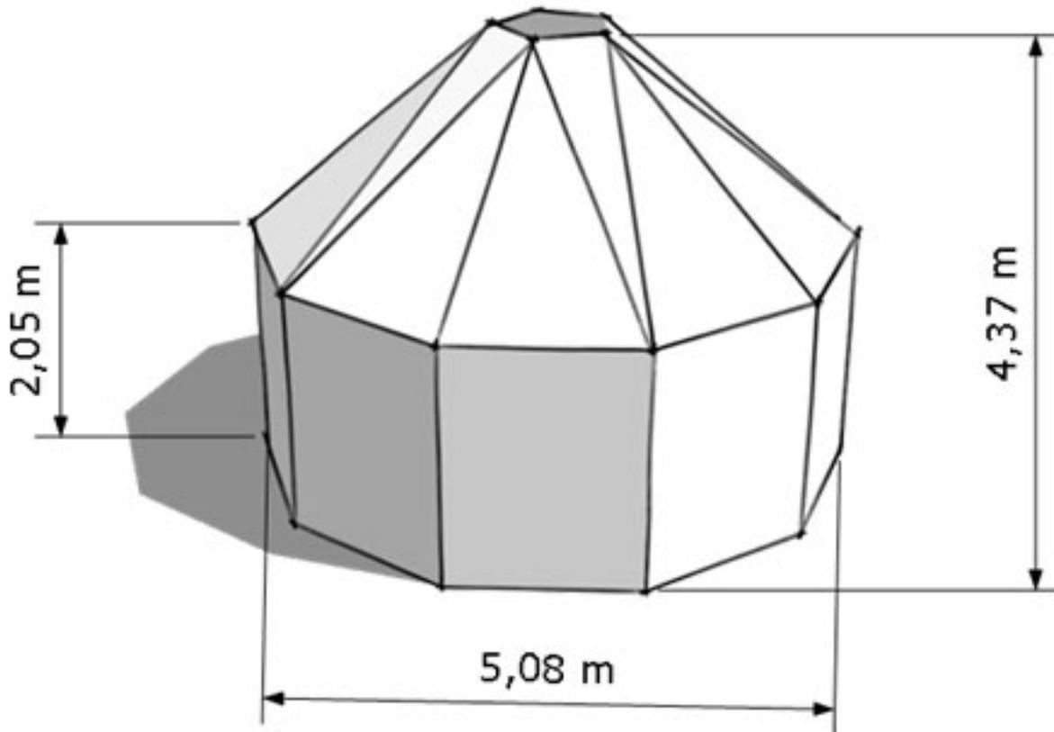
Auf fünf Kohtenblättern baust du eine Fünfer-Jurte. In der obigen Skizze siehst du die Maße einer entsprechenden Konstruktion aus Kohtenblättern und Seitenplanen.
