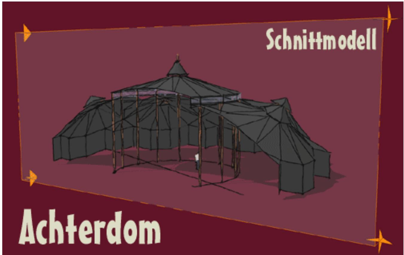
Langsam kommen wir der idealen Konstruktion mit Großjurte und acht umliegenden Jurten näher. Im Schnittmodell erkennen wir bei Verwendung der theoretischen Idealmaße, dass die Jurtendächer um etwa 32 Grad gekippt anzubringen sind.
