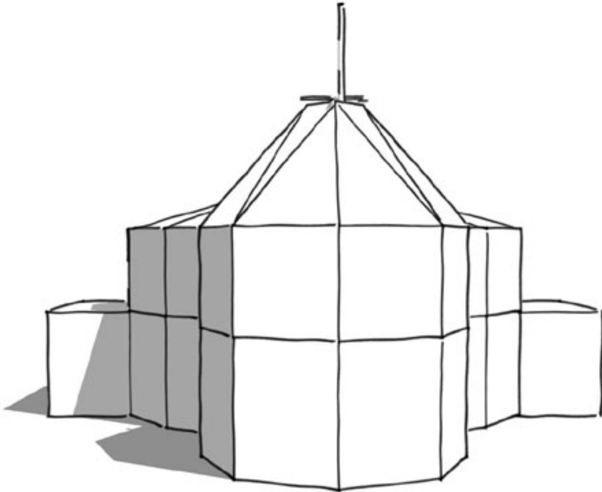
Die Seitenschiffe bleiben einstöckig. Diese über zwei Felder sauber abzuspannen wird nicht ganz trivial sein. Zumal wichtig ist, dass keine ebenen Flächen entstehen, in denen sich Regenwasser sammeln kann. Hier gilt es zu beachten, dass die Dachfläche der Seitenschiffe eine entsprechende Dachneigung bekommt.
